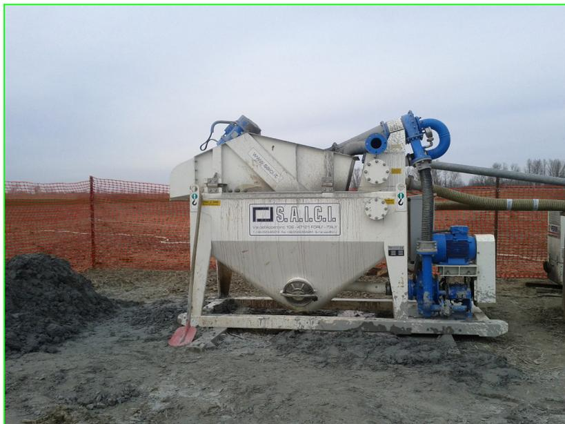
**Figura 35 – Esempio di vibrovaglio utilizzato in cantiere.**
