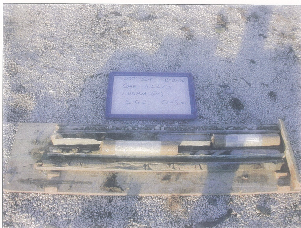
Fotografia 3: carotaggio del sondaggio SG2
