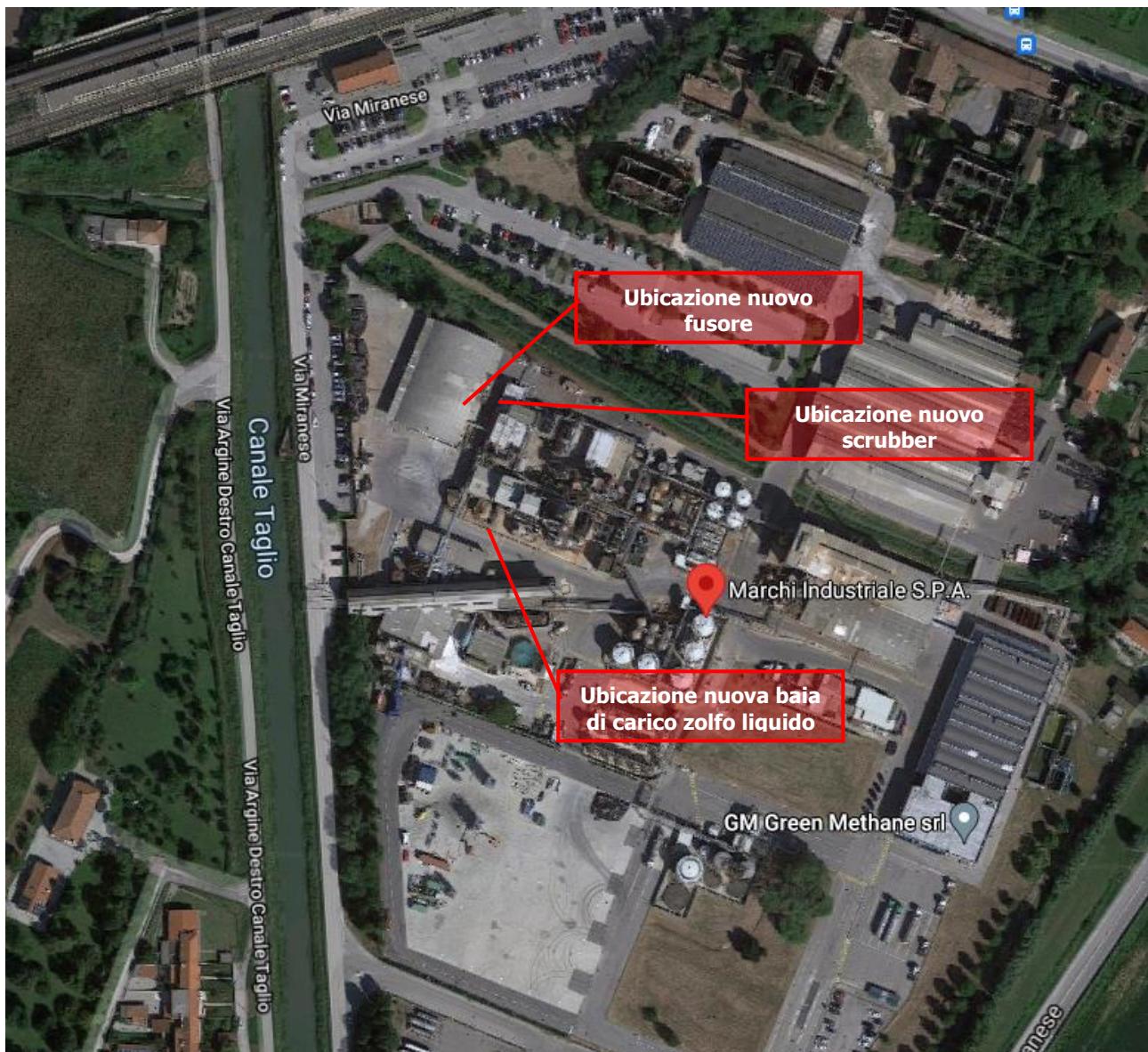
Fig. 4 - Posizione dei nuovi impianti
