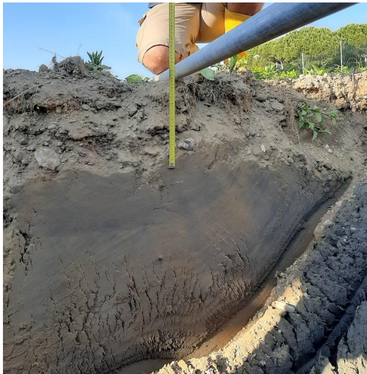
Figura 13: Scavo numero 3. Profondità materiale inerte 30 cm
