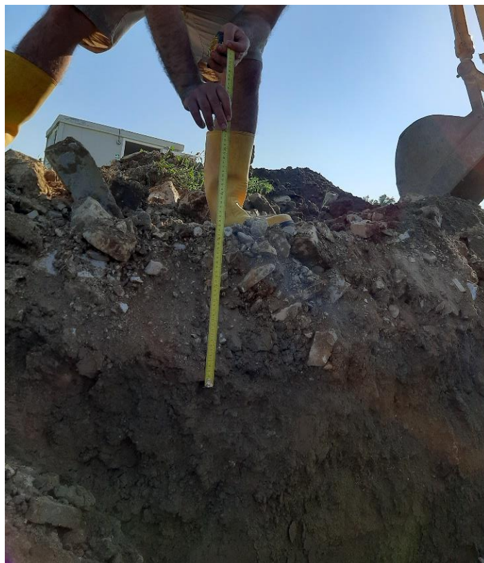
Figura 10: Scavo numero 2. Profondità materiale inerte 40 cm
