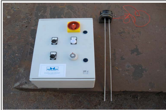
Quadro elettrico e sonde rilevamento oli
