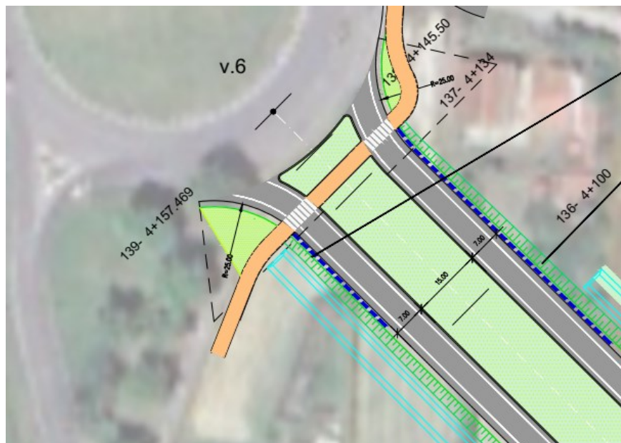
Figura 9 - Planimetria del posizionamento delle barriere acustiche (segnate in blu) in prossimità della rotatoria sulla SP 42.
