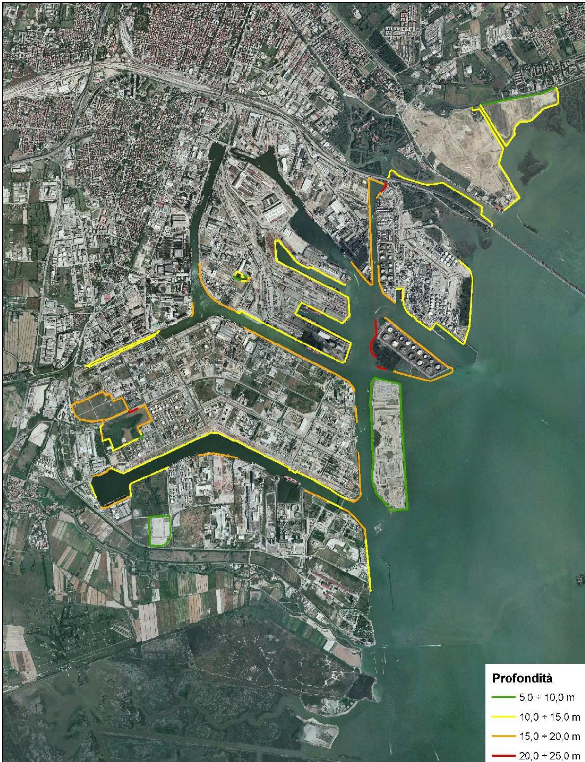
Figura 8.5.4.9.2 - Profondità dei marginanti ultimati o con misure di sicurezza presenti
