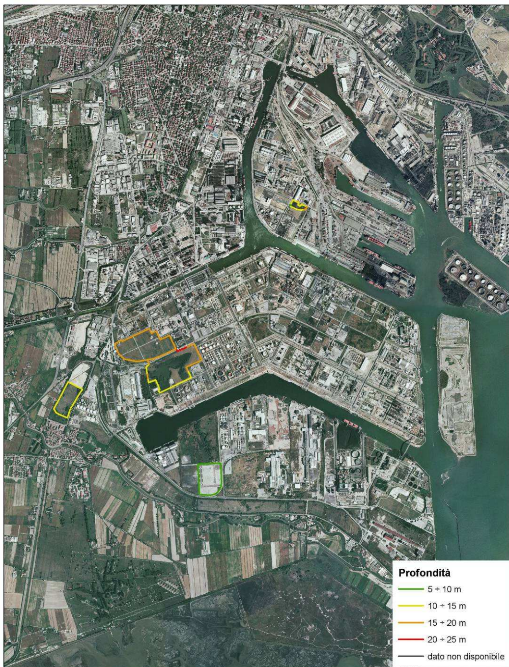
Figura 8.5.4.8.1 - Diaframmi realizzati come misure di messa in sicurezza permanente.
