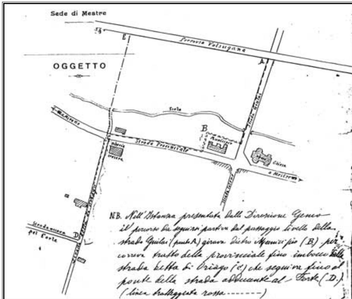
Piantina con il tracciato della ferrovia Decauville che la ditta Rizzani realizzò durante la costruzione del forte Sirtori (A.C.C.)
