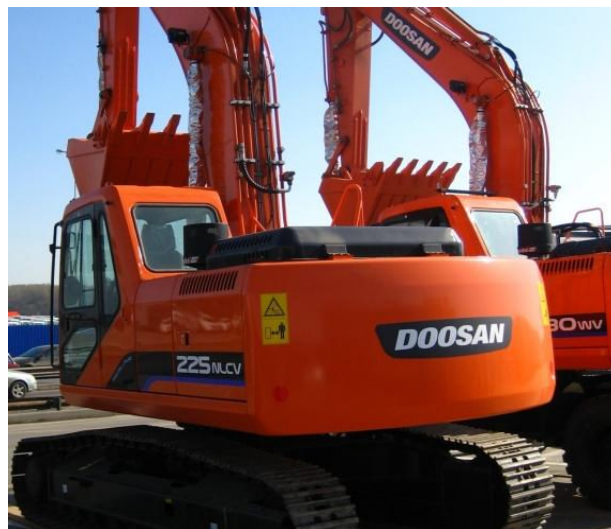
Figura 2 – Escavatore mod. DOOSAN Solar225nlcv.
