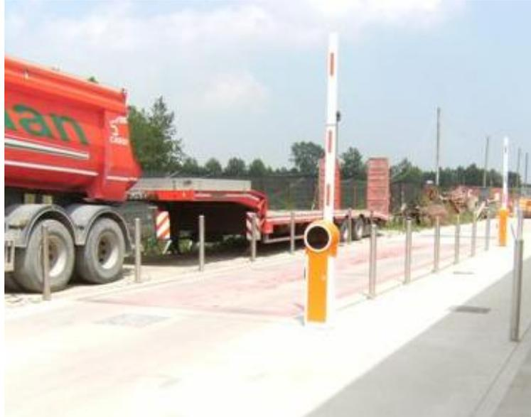
Figura 12 - Pesa Burimec mod. M/E 14x3 in uso presso la Ditta.
