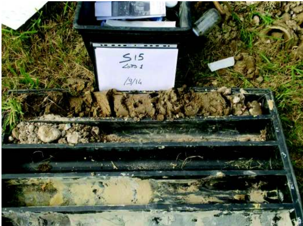
Sondaggio S15 (0,0-1,2 m dal p.c.)
