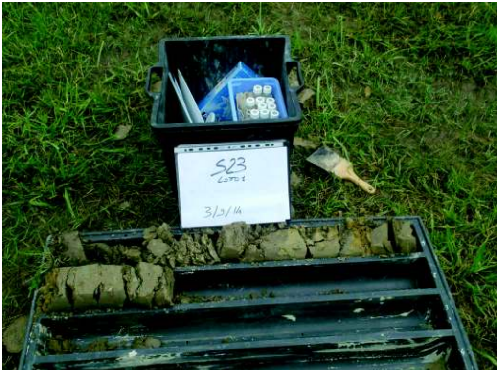
Sondaggio S23 (0,0-1,2 m dal p.c.)
