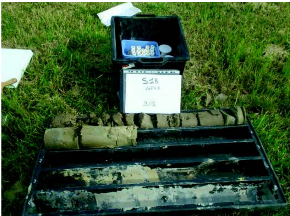
Sondaggio S18 (0,0-1,2 m dal p.c.)
