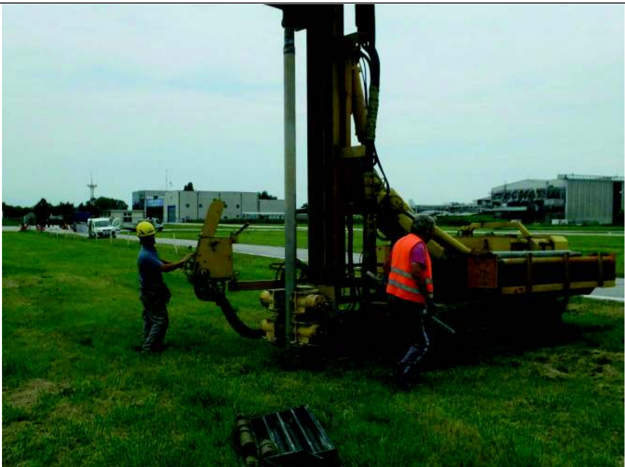
Sonda Casagrande C4 utilizzata durante le indagini
