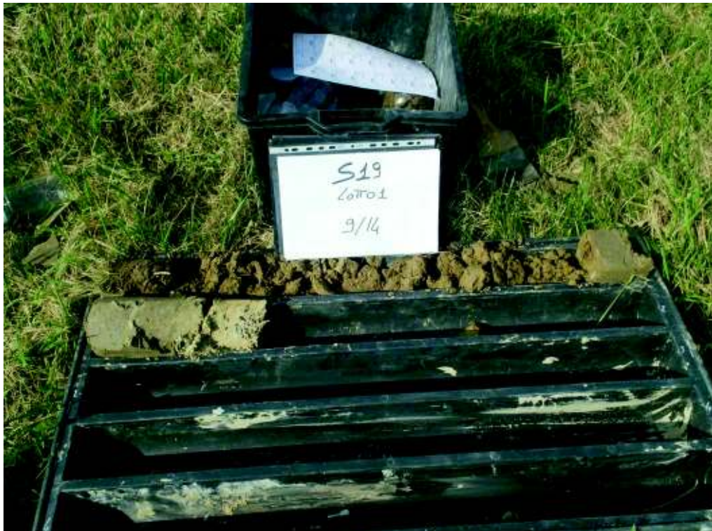
Sondaggio S19 (0,0-1,2 m dal p.c.)
