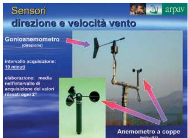
Fig. 11.42 - Sensori della stazione meteorologica: l'anemometro e l'anemoscopio per la misura della velocità e della direzione del vento.
