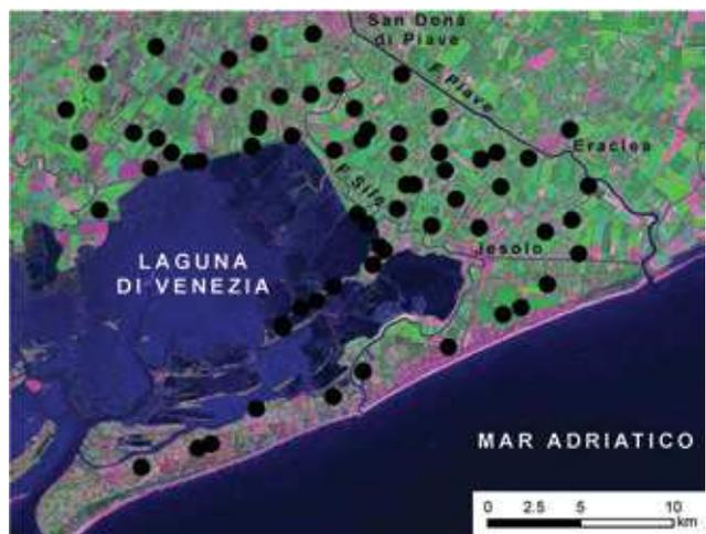
Fig. 17.6 - Ubicazione dei SEV (Sondaggi Elettrici Verticali) nell'area di studio settentrionale.
