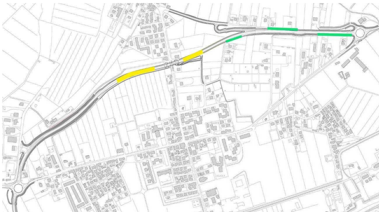
Ubicazione delle barriere acustiche di progetto (in giallo la parte di tracciato in trincea).
