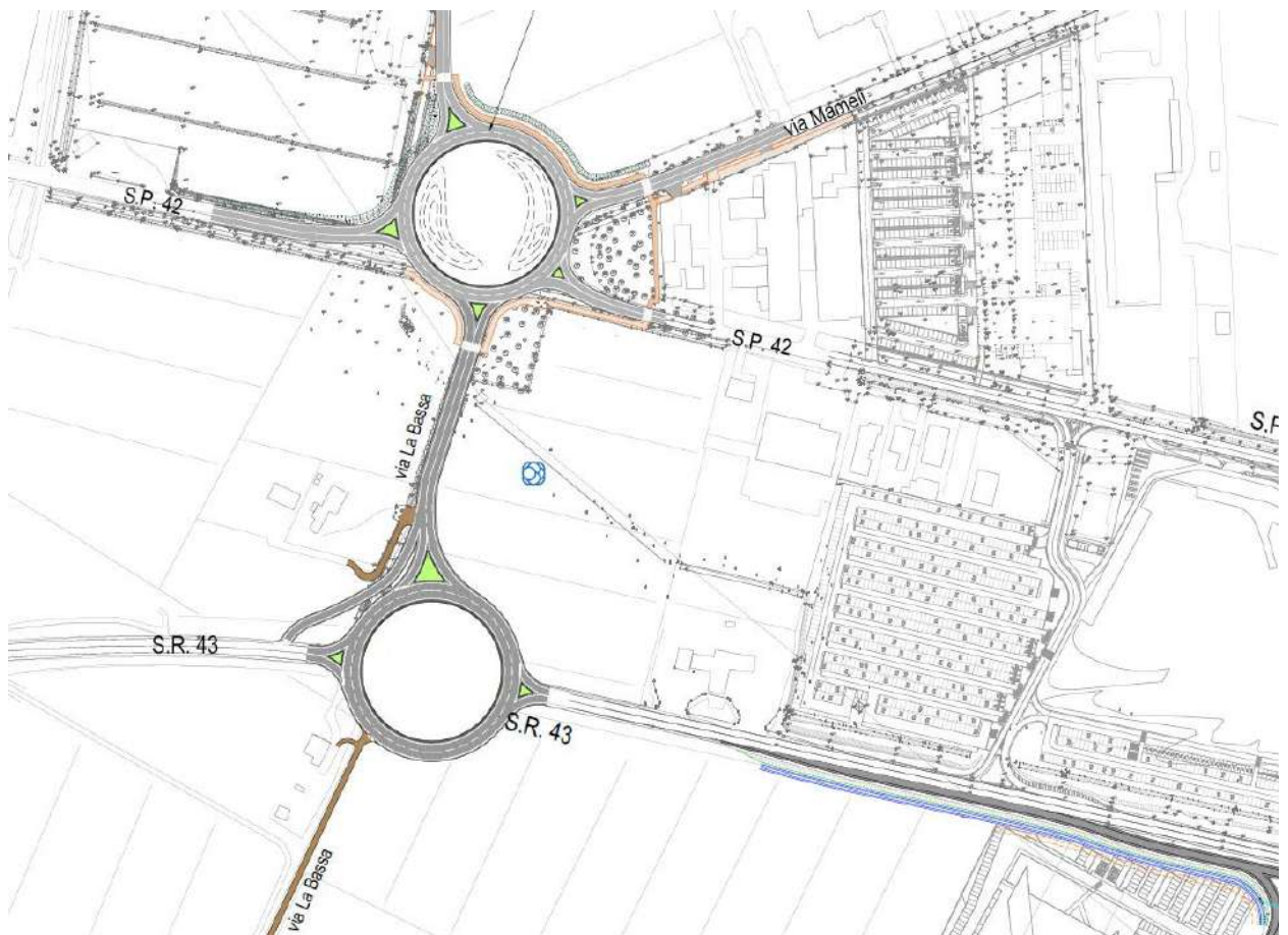
Configurazione planimetrica del sistema di rotatorie all'intersezione della SR 43, via La Bassa e SP 42.
