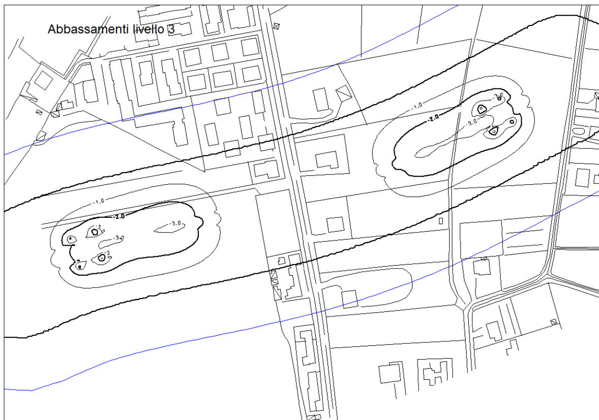
Figura 29 – Abbassamenti del livello piezometrico nel livello acquifero 3
