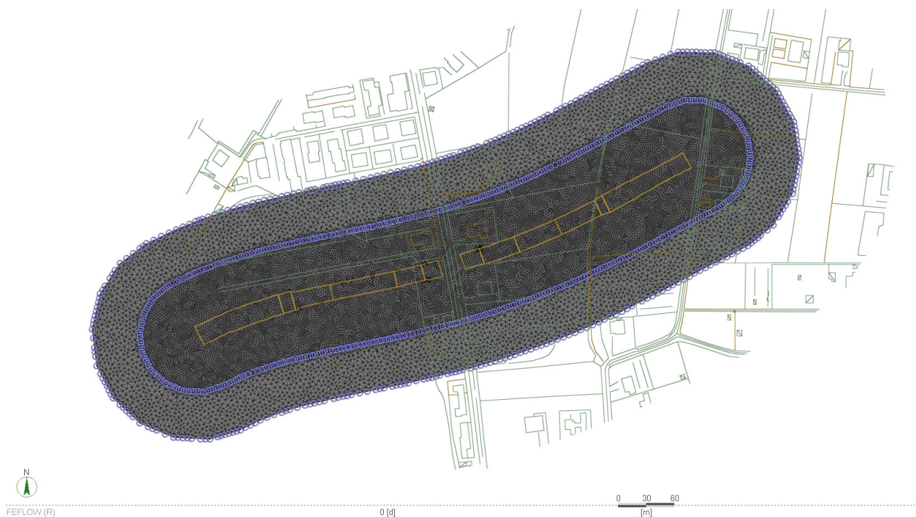
Figura 27 - Vista bidimensionale in pianta della mesh di calcolo con ubicazione dei nodi cui sono state assegnate le condizioni al contorno di carico idraulico costante
