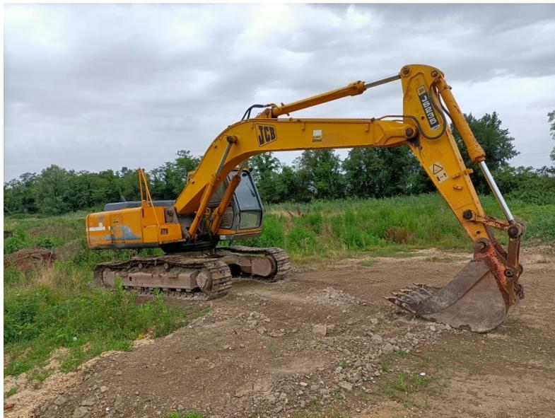
Figura 5: Foto escavatore JCB modello JS235
