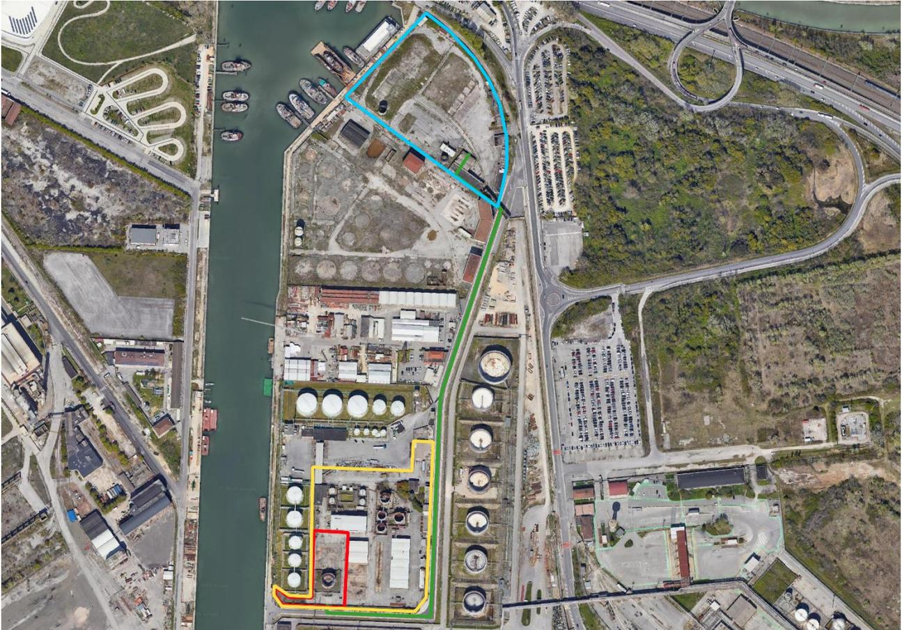
*Figura 1 - area oggetto di intervento in concessione alla Joint Venture (in rosso), area di proprietà di AGSM-AIM S.p.A. (in giallo), area con infrastrutture per la distribuzione dell'idrogeno e il deposito degli autobus (in blu) collegata all'area di produzione idrogeno con idrogenodotto interrato (in verde).*
