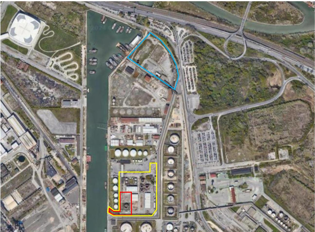
*Figura 1 - area oggetto di intervento in concessione alla Joint Venture (in rosso), area di proprietà di AGSM-AIM S.p.A. (in giallo), area con infrastrutture per la distribuzione dell'idrogeno e il deposito degli autobus (in blu) collegata all'area di produzione idrogeno con idrogenodotto interrato*
