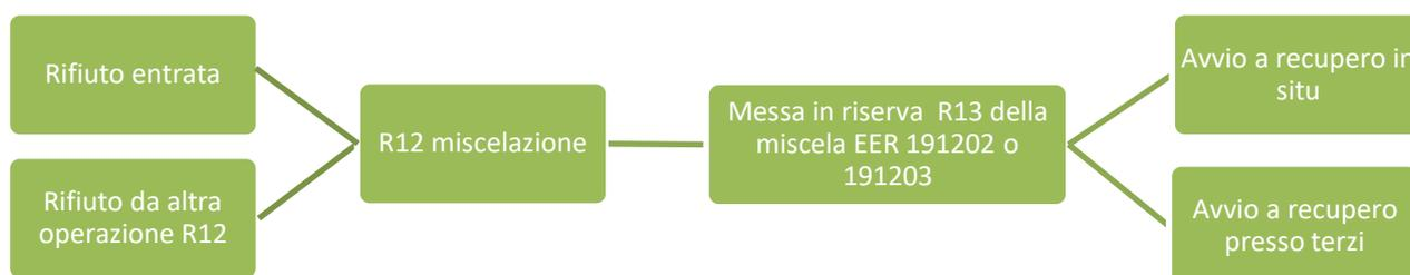
**Figura 12 - Schema gestione rifiuti sottoposti all'operazione di scambio di rifiuti R12 MISCELAZIONE.**
