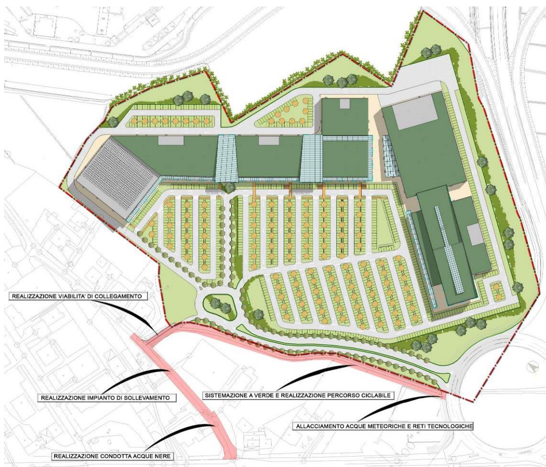
Planimetria del progetto con indicazione delle opere compensative di urbanizzazione.
