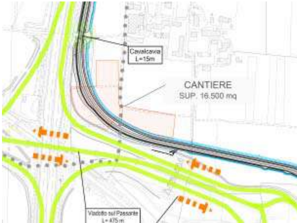
Figura 52 - Area di cantiere fisso per la realizzazione della Bretella in esame
