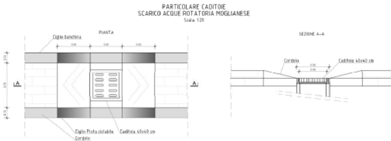
Figura 38 – Sistema di smaltimento delle acque sulla rotatoria moglianesa
