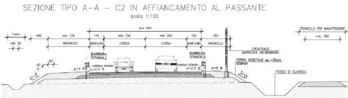
Figura 23 - Sezione tipo piattaforma C2 in affiancamento al passante
